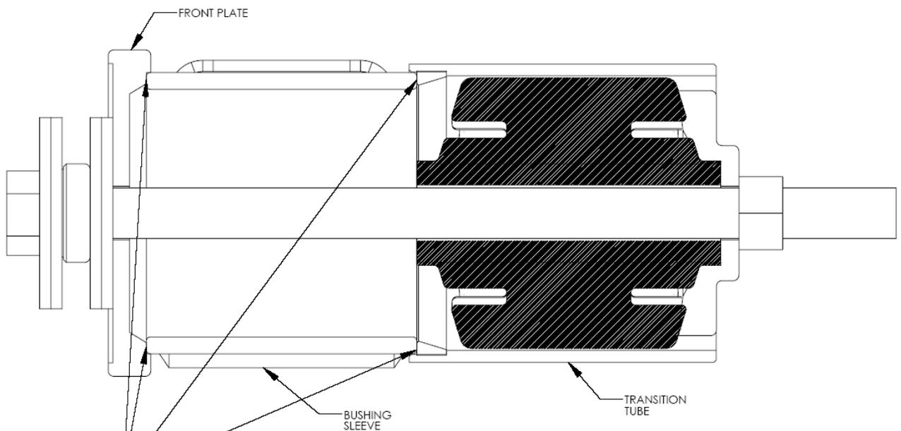
MAKE SURE THE TOOL IS SQUARELY SEATED ON BOTH SIDES OF THE BUSHING TUBE
